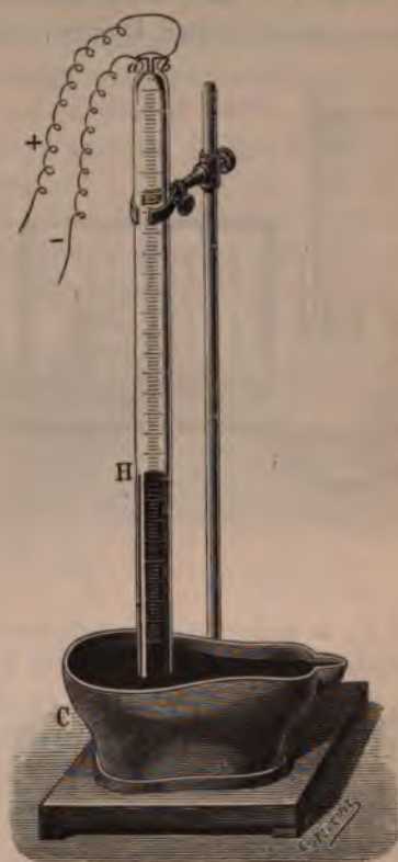
Fig. 29. — Eudiomètre de M. Riban. Les deux fils métalliques a et b traversent la masse de verre du haut de l'eudiomètre et viennent affleurer à l'intérieur très près l'un de l'autre. L'étincelle éclate entre les deux extrémités métalliques intérieures.
